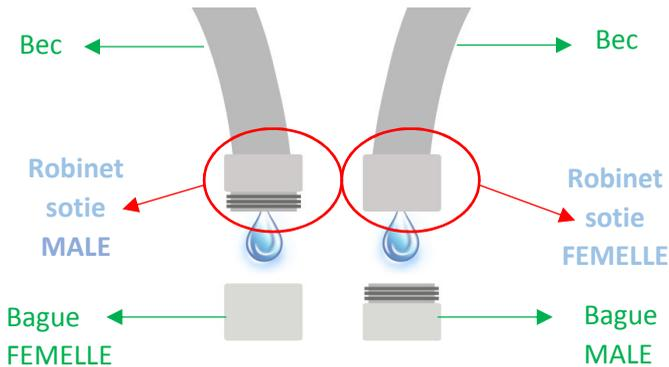
**Dévisser**, manuellement la bague. Si celle-ci est trop serrée ou grippée. Entourer la d'un chiffon pour ne pas l'abîmer et utiliser une pince multiprise.
