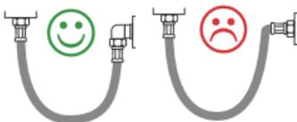
Pour une pose entre un point horizontal et un point vertical et inversement **Le raccordement se doit d'être fait avec un coude pour le point horizontal**. Comme pour les autres types de pose, le flexible ne doit pas être tendu.
